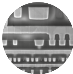
СЭМ изображение Логическое устройство – технология 65 nm. Источник: FEI Company
